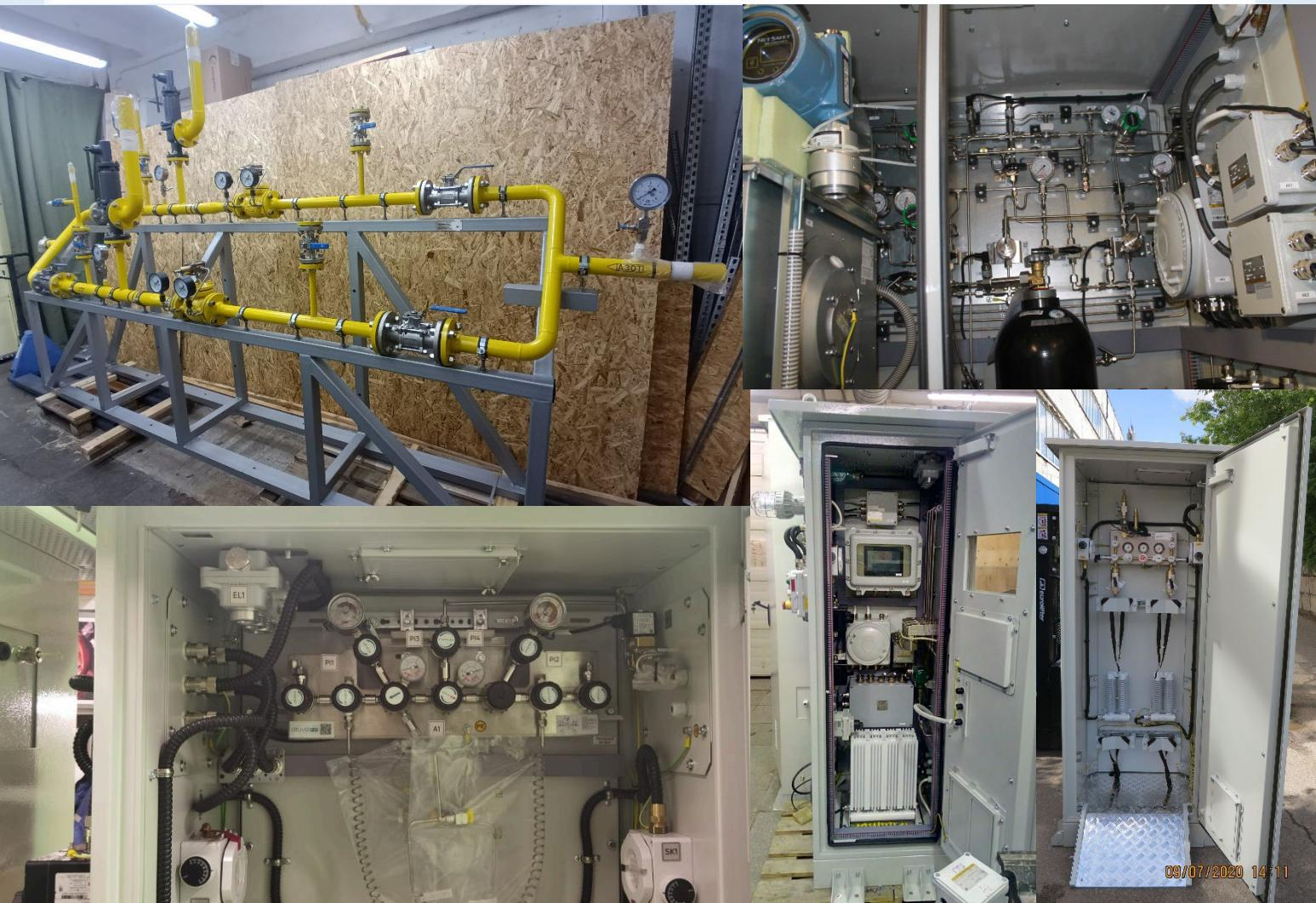
**Разрядные и перепускные рампы**, выпускаемые ООО «Технодизайн-М», широко применяются в различных отраслях производства для подачи и регулирования сварочных, технологических, лабораторных газов, и могут выполнять, в зависимости от требований заказчика, следующие функции:
