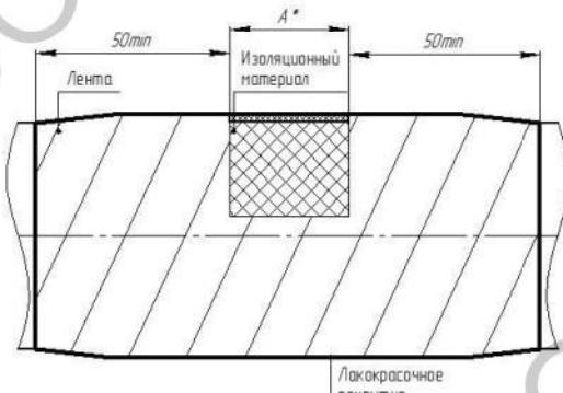
Вариант 1 Ремонт с нанесением защитного ЛКП.
