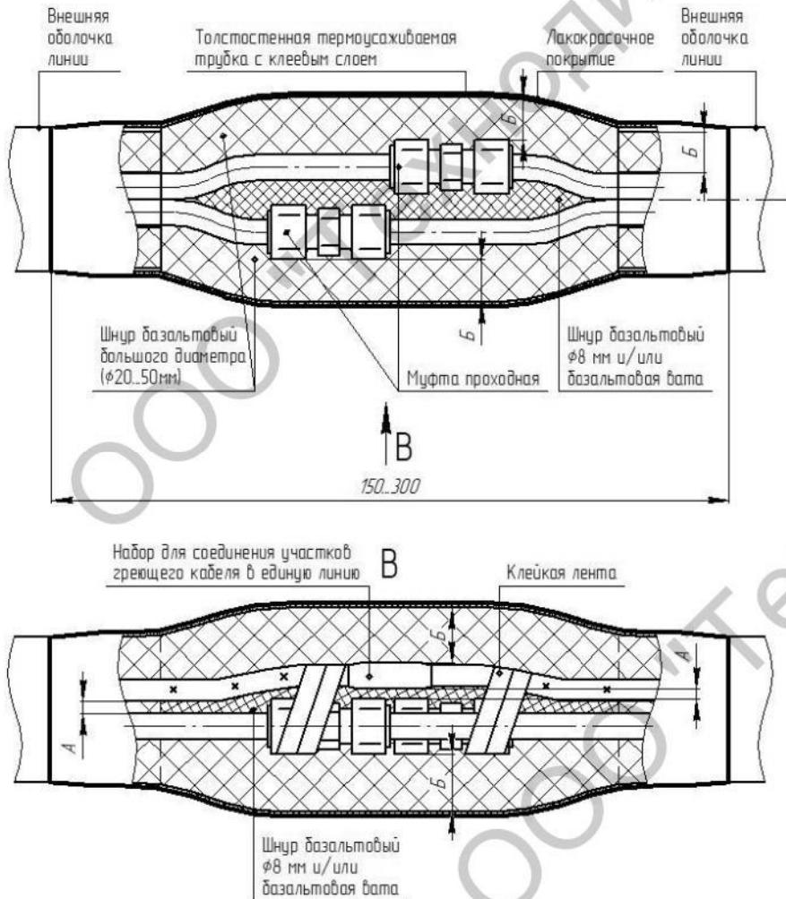
Рисунок 6 - Монтаж комплекта ТДМ-ТИЛ-Э-Ех-КСУЛ.
