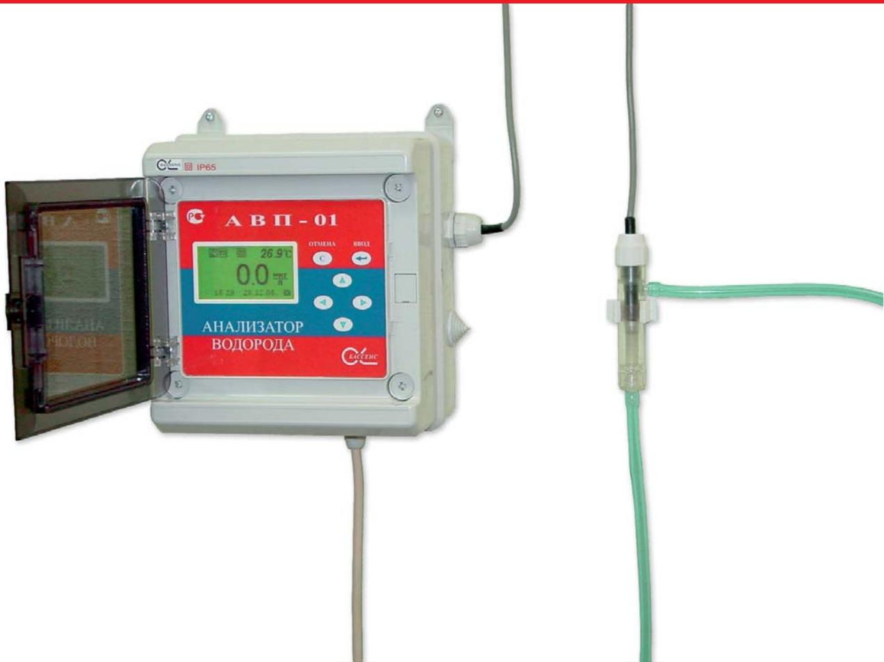
Анализаторы АВП-01Т и АВП-02Т в комплекте с АС-04 соответственно и проточной измерительной камерой предназначены для измерений концентрации водорода и температуры в потоке жидкостей. Применяются при аналитическом контроле и управлении процессами водохимподготовки в тепловой и атомной энергетике: ТЭЦ, ГРЭС, АЭС, теплосети и котельные.
