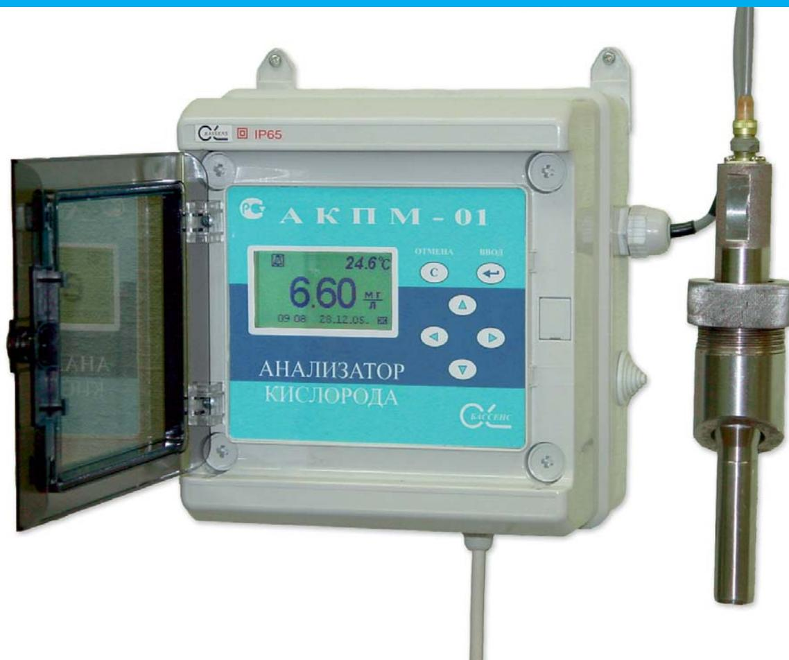
Анализатор АКПМ-1-01А в комплекте с АС-06 предназначен для производственного контроля растворенного кислорода в мили- и микрограммовом диапазоне концентраций в первом контуре охлаждения ядерных реакторов.
