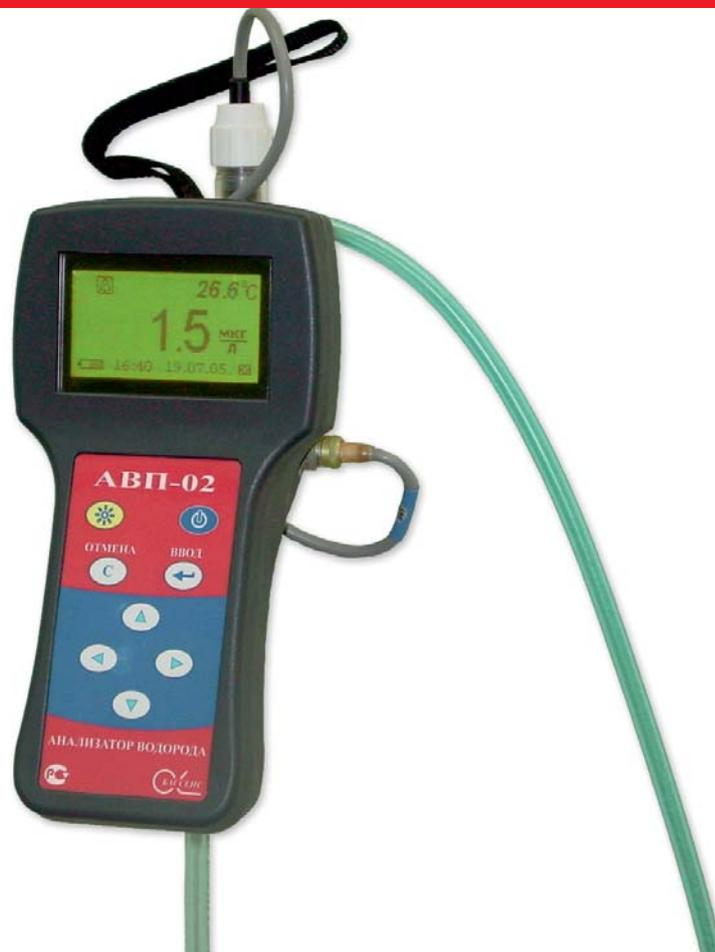
Анализаторы АВП-01Т и АВП-02Т применяются для контроля процессов высокотемпературной коррозии технологического оборудования. Анализаторы также применяются в химической, нефтеперерабатывающей промышленности и в других областях народного хозяйства.
