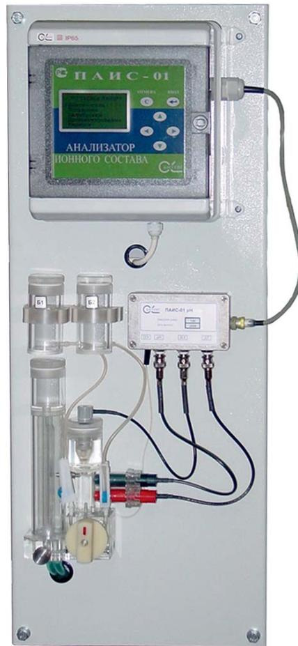
Анализаторы ПАИС-01pH и ПАИС-02pH предназначены для производственного и оперативного контроля активности ионов водорода (pH) в технологических жидкостях на предприятиях тепловой и атомной энергетики, в пищевой, химической, целлюлозно-бумажной, нефтеперерабатывающей промышленности и др. отраслях народного хозяйства.
