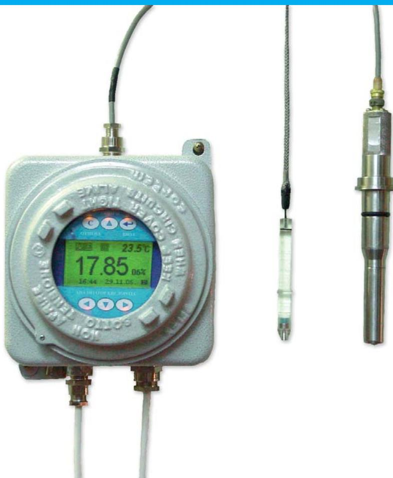
Конструкция АС-06 (см. стр. 20) снабжена компенсатором давления и системой защитных мембран, армированных сеткой из нержавеющей стали, благодаря которым АС-06 выдерживает давление до 25 атм и стерилизацию острым паром при температуре 143 °С.
