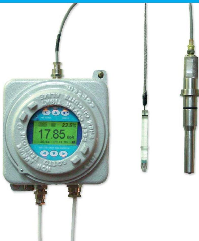
Промышленные анализаторы кислорода марки АКПМ могут выпускаться во взрывозащищенном исполнении по ГОСТР30852.0, ГОСТР30852.1, ГОСТР30852.10 соответствуют ТР ТС 012/2011 с уровнем взрывозащиты «взрывобезопасный» для взрывоопасных смесей газов и паров с воздухом категории IIС температурной группы Т6. Анализаторы во взрывозащищенном исполнении имеют маркировку взрывозащиты **1Exd[ib]IIC T6 X** и предназначены для применения во взрывоопасных зонах согласно ГОСТР30852.9, ГОСТР30852.13.
