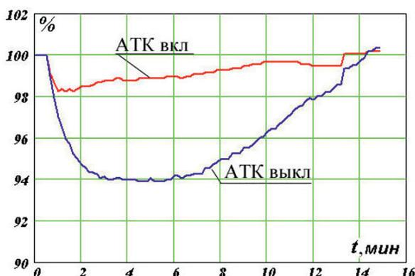
Благодаря такому расположению датчика температуры, снижается инерционность работы системы термокомпенсации, повышается ее точность и снижаются ошибки калибровки и измерений, обусловленные эффектом «охлаждения» мембраны.
