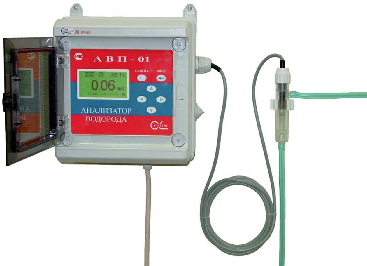
Газоанализаторы АВП-01Г и АВП-02Г предназначены для непрерывного определения концентрации и/или парциального давления водорода в газовых средах.
