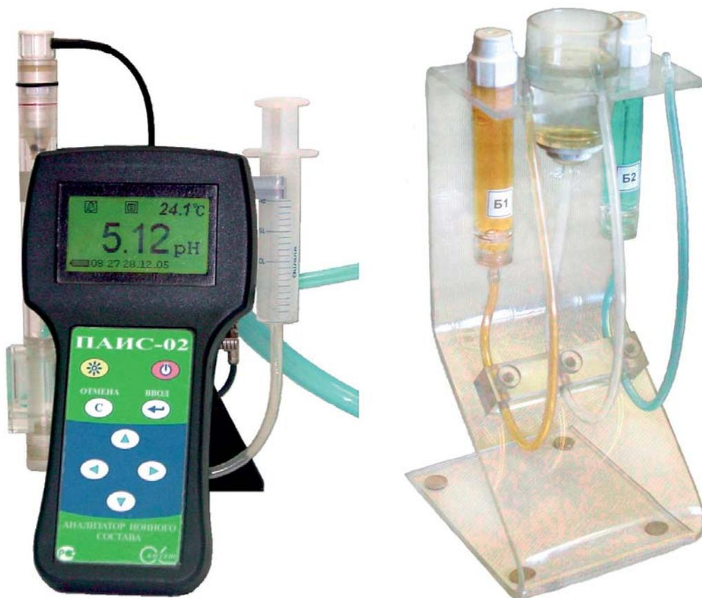
Анализаторы ПАИС-02pH позволяют проводить оперативные измерения pH непосредственно в пробоотборных точках в анаэробных условиях, исключающих возможность окисления, загрязнения пробы и дегазации из нее летучих компонентов.
