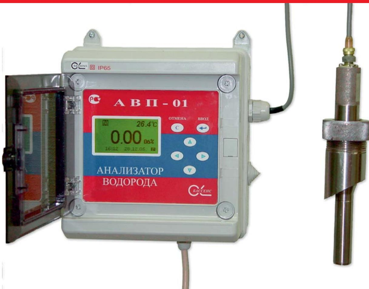
Анализаторы АВП-01А и АВП-11А в комплекте с АС-06 предназначены для производственного контроля концентрации растворенного водорода в милли- и микрограммовом диапазонах концентраций в первом контуре охлаждения ядерных реакторов, а также при автоматическом контроле процессов водохимподготовки на предприятиях тепловой и атомной энергетики, в теплосетях и на промышленных предприятиях.
