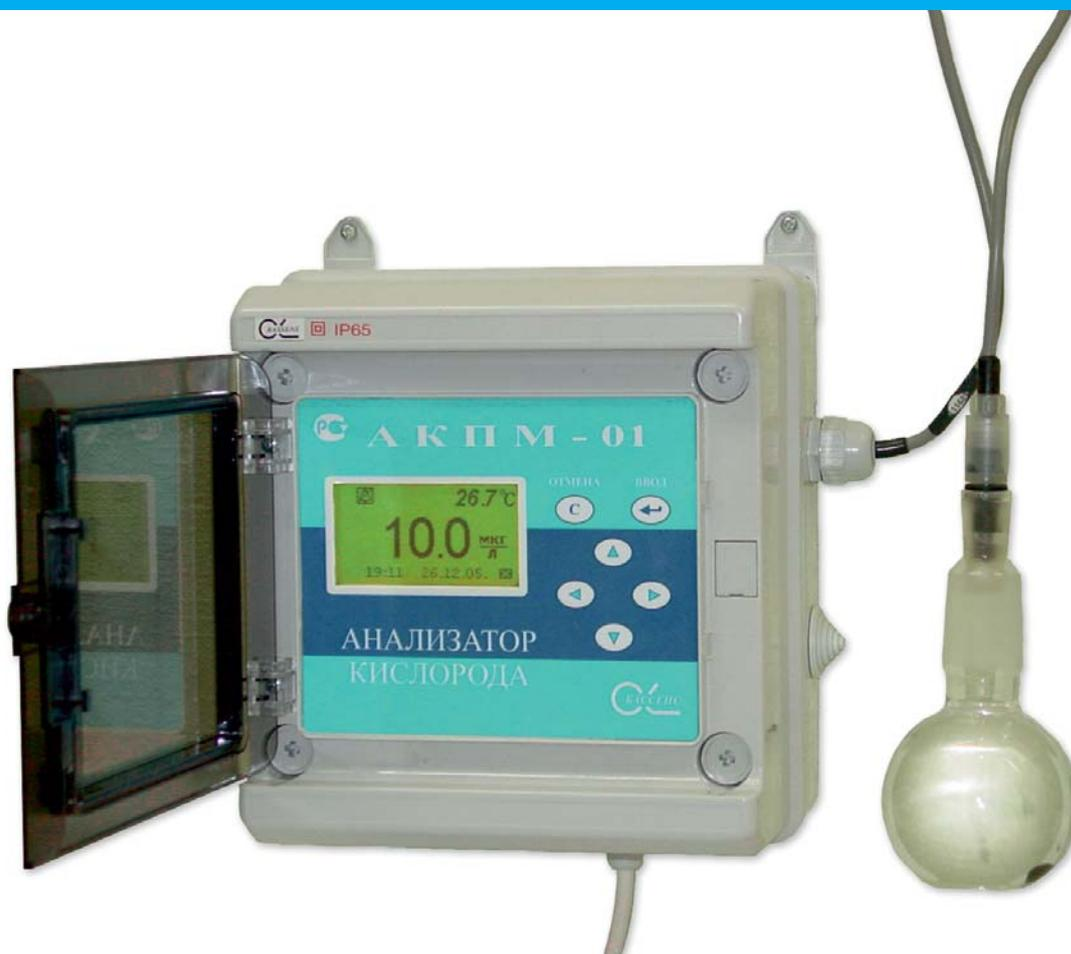
Анализаторы АКПМ-1-01Л и АКПМ-1-02Л в комплекте с АС-01 предназначены для измерений концентрации и биохимического потребления кислорода (БПК) в природных и сточных водах, регистрации кинетики процессов биологического окисления веществ и для тестирования токсичности стоков.
