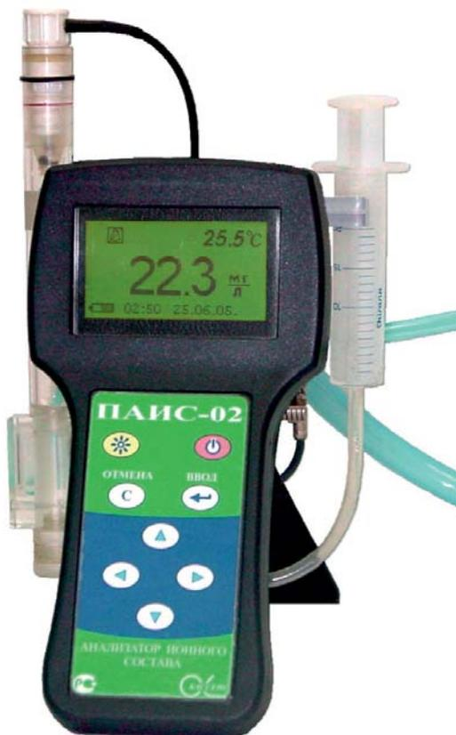
Анализаторы ПАИС-02pNa позволяют проводить оперативные измерения pNa непосредственно в пробоотборных точках в анаэробных условиях, исключающих возможность окисления, загрязнения пробы и дегазации из нее летучих компонентов.
