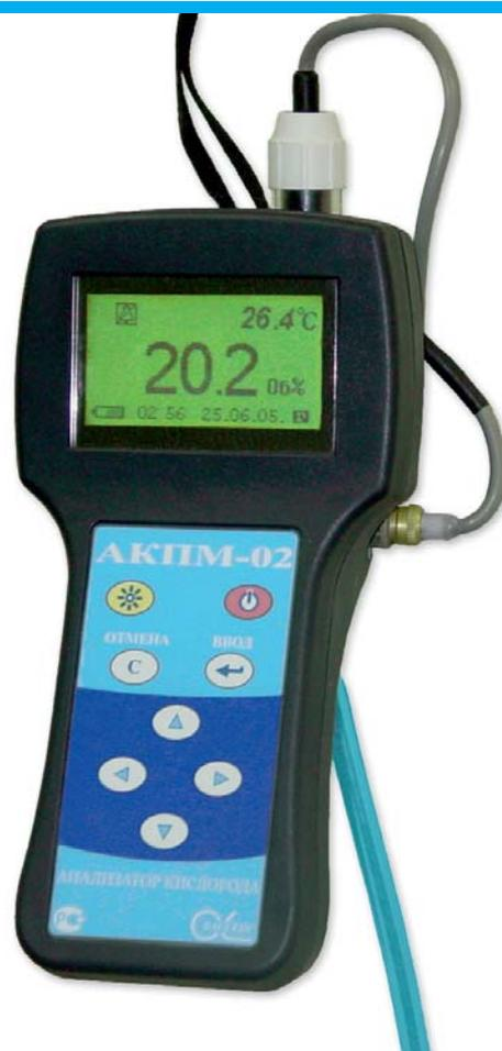
Газоанализатор АКПМ-1-02ГМ предназначен для определения концентрации и/или парциального давления кислорода в газовых средах. Анализатор оснащен встроенным микрокомпрессором, с помощью которого осуществляется автоматический забор анализируемого газа из дымоходов, колодцев, котлов, цистерн, емкостей и сосудов находящихся как под разряжением, так и при избыточном давлении.
