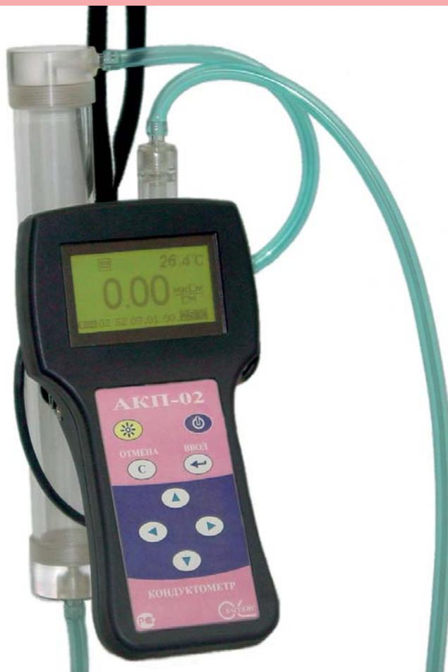
На ТЭЦ, АЭС и в теплосетях анализаторы применяются для непрерывного контроля и автоматического управления процессами химической водоподготовки, в том числе глубокого химического обессоливания, а также для оценки качества работы теплотехнического и технологического оборудования.
