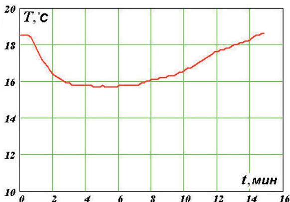
Экспериментальный график изменения температуры ГМ (рис.2) амперометрического сенсора показывает, что при калибровке по воздуху температура мембраны значительно изменяется за счет испарения влаги с ее поверхности.
