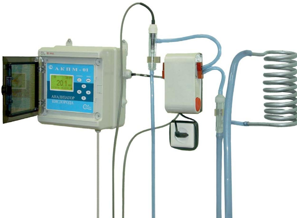
Газоанализаторы АКПМ-1-01Г и АКПМ-1-02Г предназначены для непрерывного определения концентрации и/или парциального давления кислорода в газовых средах.
