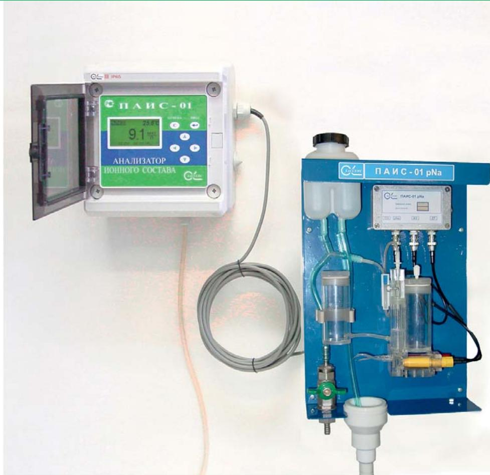
Анализаторы ПАИС-01pNa и ПАИС-02pNa предназначены для производственного и оперативного контроля активности ионов натрия (pNa) в технологических жидкостях на предприятиях тепловой и атомной энергетики, в пищевой, химической, целлюлозно-бумажной, нефтеперерабатывающей промышленности и других отраслях народного хозяйства.
