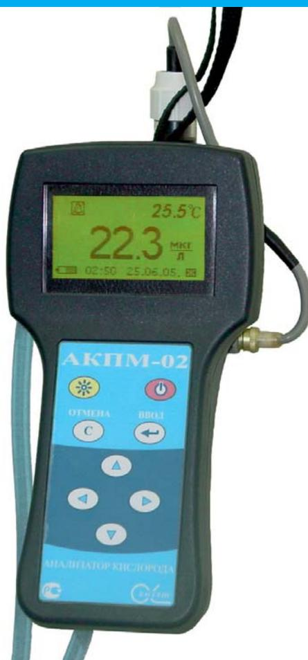
Анализаторы АКПМ-1-02Т и АКПМ-1-01Т также могут использоваться в автоматизированных системах контроля и управления технологическими процессами в химической, пищевой, микробиологической, микроэлектронной и фармацевтической промышленности. Анализаторы также находят применение в научно-исследовательских институтах при проведении фундаментальных исследований по изучению явлений коррозии металлов, механизмов растворимости и массообмена кислорода в жидкостях.
