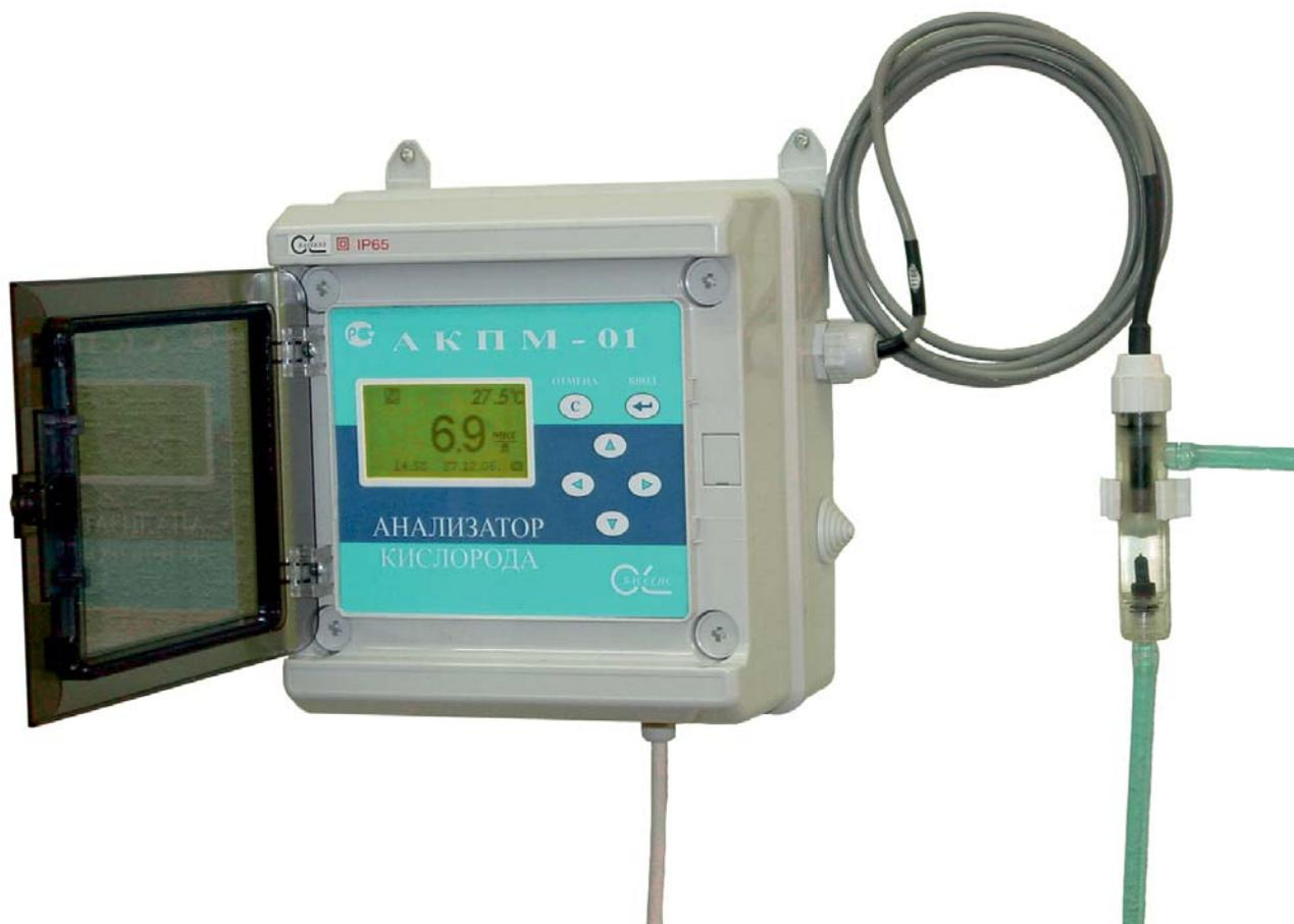
Анализаторы АКПМ-1-02Т и АКПМ-1-01Т (в комплекте с АС-04) предназначены соответственно для оперативного и производственного контроля растворенного кислорода в мили- и микрограммовом диапазоне концентраций. Анализаторы применяются при оперативном и автоматическом контроле процессов водохимподготовки в тепловой и атомной энергетике, в теплосетях и на промышленных предприятиях.
