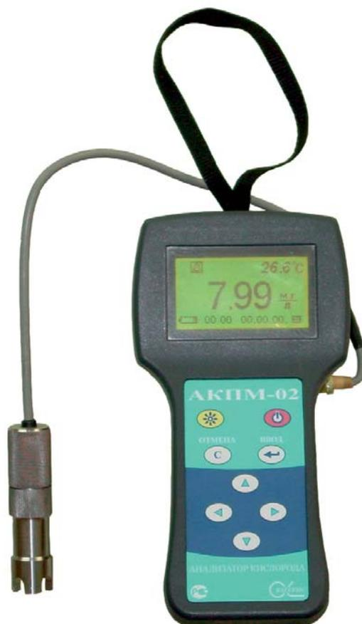
Анализаторы применяются при оперативном (АКПМ-1-02П) и автоматическом (АКПМ-1-01П) контроле и управлении процессами биологической очистки сточных вод на очистных сооружениях водоканалов и промышленных предприятий, в жилищно-коммунальных и рыбоводческих хозяйствах, в ЦГСЭН и организациях Госкомприроды - при контроле и экспертизе качества питьевых, природных и сточных вод.
