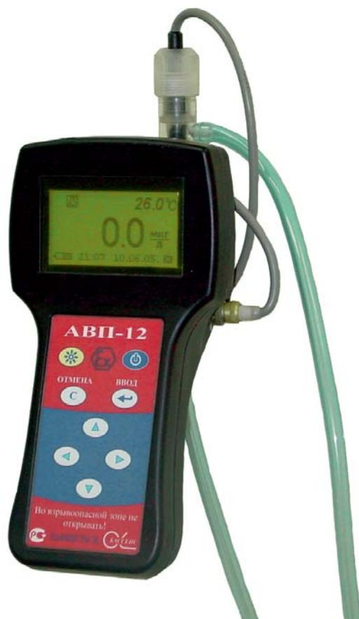
Портативные анализаторы водорода марки АВП могут выпускаться во взрывозащищенном исполнении по ГОСТР30852.0, ГОСТР30852.1, ГОСТР30852.10 соответствуют ТР ТС 012/2011 с уровнем взрывозащиты «искробезопасная электрическая цепь уровня «ib» для смеси газов и паров с воздухом категории IIC, групп T6.
