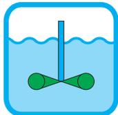
Сенсор снабжен встроенной электромагнитной мешалкой для предотвращения «обрастания» сенсора.
