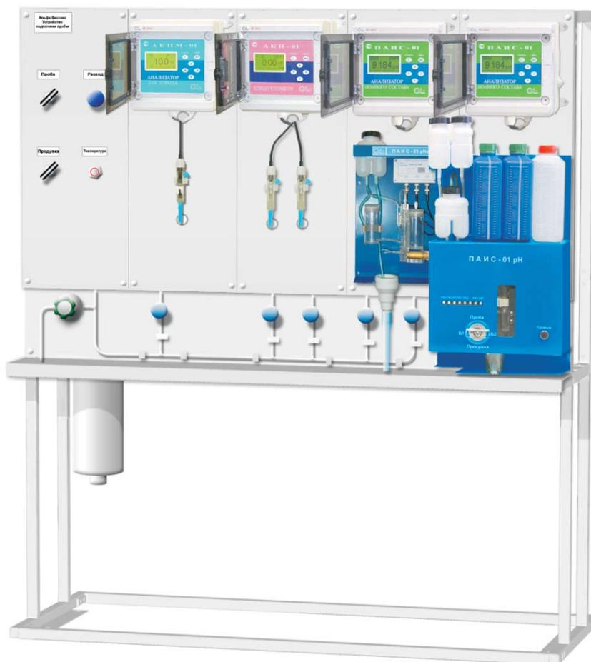
СУПП предназначено для отбора, подготовки и подачи анализируемой пробы водного и парового теплоносителей с температурой от  $+30$  до  $+565^{\circ}\text{C}$  и давлением от  $0,6$  до  $31\text{МПа}$  на автоматические приборы химического контроля процессов химводоподготовки, а также обеспечивает отбор пробы для ручного анализа.
