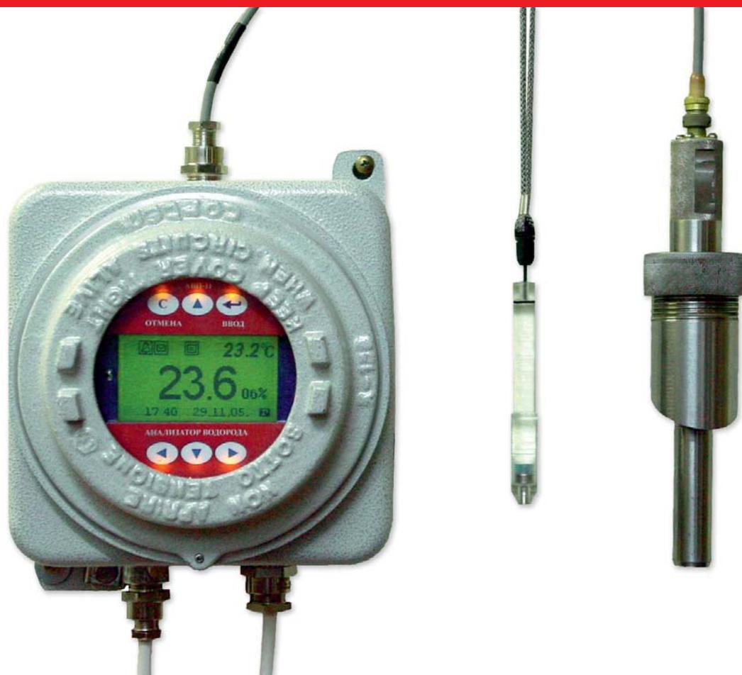
Конструкция АС-06 (см. стр. 20) снабжена компенсатором давления и системой защитных мембран, армированных сеткой из нержавеющей стали, благодаря которым АС-06 выдерживает давление до 25 атм и стерилизацию острым паром при температуре 143 °С.
