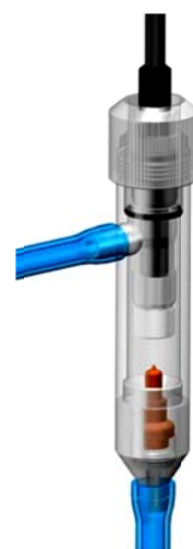
Рис. 3.7. Фиксация АСрН 2 в измерительной камере.
