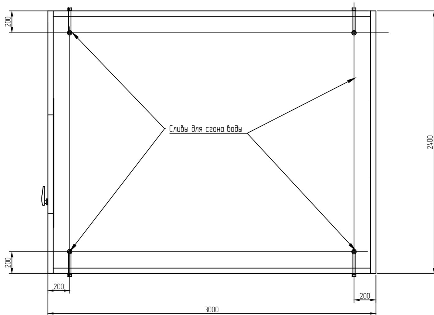
Крепить шкаф к бетонному основанию следует в точках крепления в соответствии с чертежом. Крепление осуществить анкерными болтами. Диаметр крепежных отверстий 12мм. Размеры бетонного основания даны для справки и могут быть изменены заказчиком. Уклон основания в любой горизонтальной оси не должен превышать 2 градуса.
