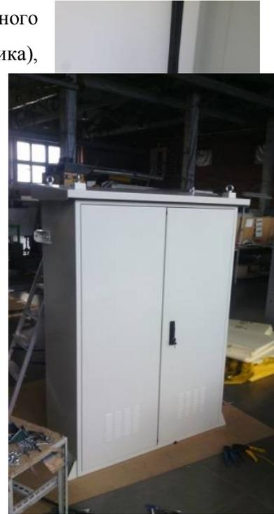
импортного производства, отличающихся высотой и диаметром. Для фиксации баллона в ложементе используются цепи или тканевые ремни с затяжными фиксаторами. В шкафу предусмотрено место с креплениями для установки разрядных рампы. В шкаф могут быть установлены, как серийно выпускаемые разрядные рампы производства ООО «Технодизайн-М», так и рампы других производителей.
