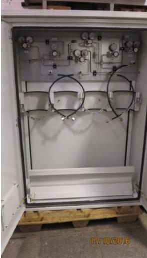
Компания ООО «Технодизайн-М» предлагает линейку шкафов марки ТШВ, выпускаемых серийно и индивидуального исполнения (по ТЗ, ТУ, ОЛ Заказчика), предназначенных для установки баллонов с газами различного назначения. Модели шкафов различаются количеством устанавливаемых баллонов и габаритными размерами. В зависимости от модификации шкафа и конфигурации внутренних ложементов возможно устанавливать баллоны всех возможных модификаций, российского и
